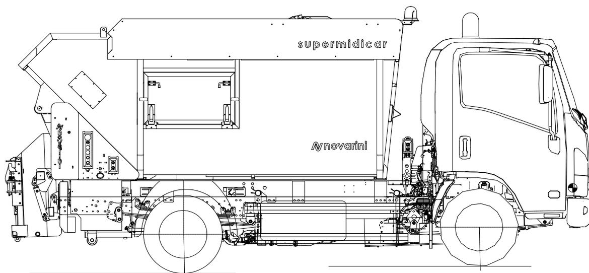
Attrezzatura Supermidicar, vasca ribaltabile posteriore realizzata in lamiera hardox 450 sp.2 con porta lato destro e apparato di compattazione, dispositivo di svuotamento posteriore contenitore fisso da 390 litri completo di dispositivo di aggancio per bidoni da 120-240-360 litri a pettine doppio e bracci per cassonetti 1100 litri attacco din. Contenitore x bottiglie olio da 25 litri in acciaio inox.
