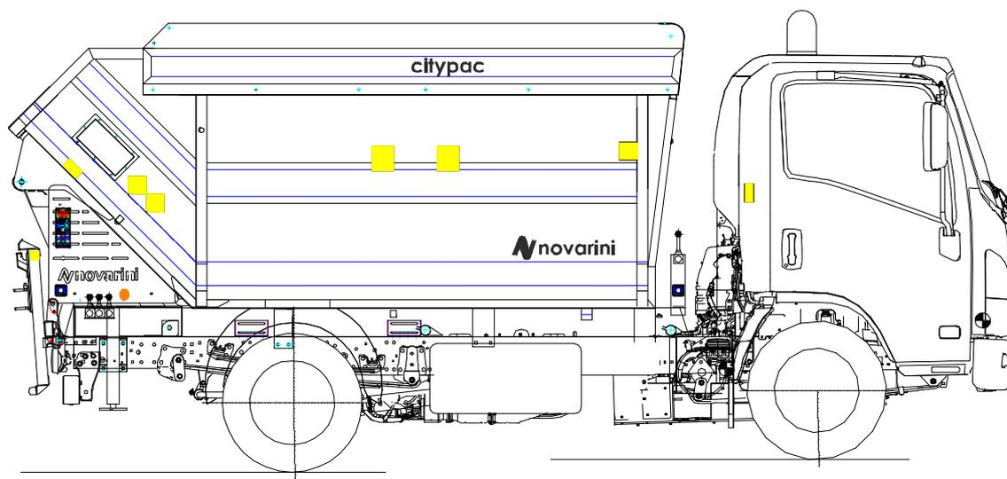
Attrezzatura Citypac vasca ribaltabile a scarico posteriore in hardox 450 sp.2mm con apparato di compattazione variabile, dispositivo voltacassonetti snodato con attacco pettine per contenitori 120-240-360 lt e bracci per cassonetti 1100lt attacco DIN.
